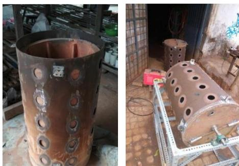
Gambar 1. Proses pembuatan alat penyangrai kopi
